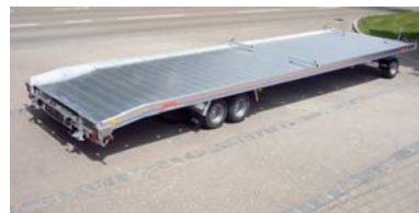
Jotha ATX-DS. Drehschemelanhänger für zwei Fahrzeuge.
