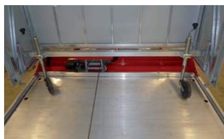
Mit der Montageeinrichtung kann der gesamte Aufbau angehoben und sicher vom Anhänger abgerollt werden.
