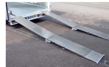
Durch die faltbaren Auffahrschienen ergibt sich ein extrem flacher Auffahrwinkel.
