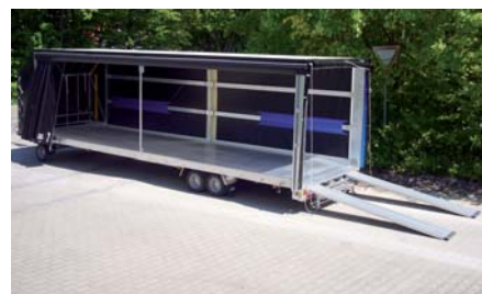
Hohe Wirtschaftlichkeit und Sicherheit bietet der Drehschemelanhängers für zwei Fahrzeuge mit Plane.
