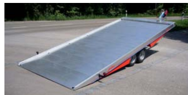
Jotha ATC-AS. Autotransportanhänger mit neigbarer Ladefläche.
