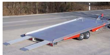
Jotha ATC-TS. Selbstkipper mit Auffahrschienen.
