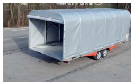
Als Verladevorbereitung wird zuerst der Heckrollo und die drei seitlichen Zurrgurte geöffnet.
