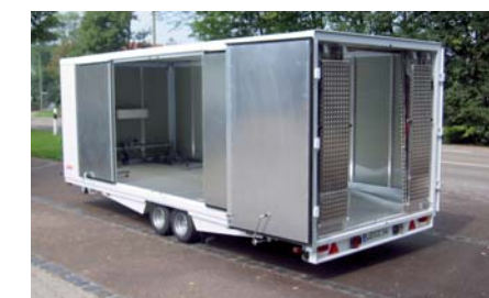
Die faltbaren Auffahrschienen sind seitenverstellbar und werden im Koffer sicher arretiert.
